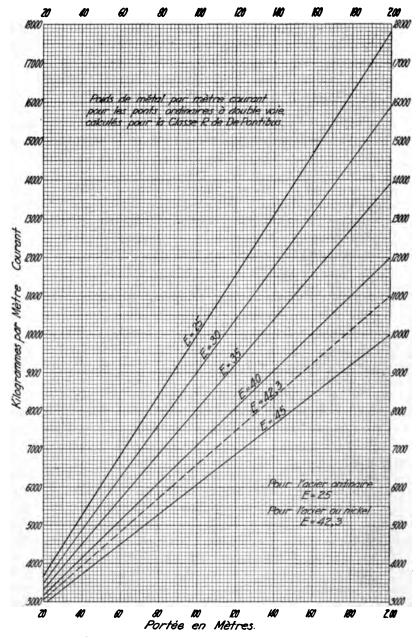
Fig. 4h. Poids de Métal par Mètre Courant pour les Ponts Ordinaires à Double Voie.
