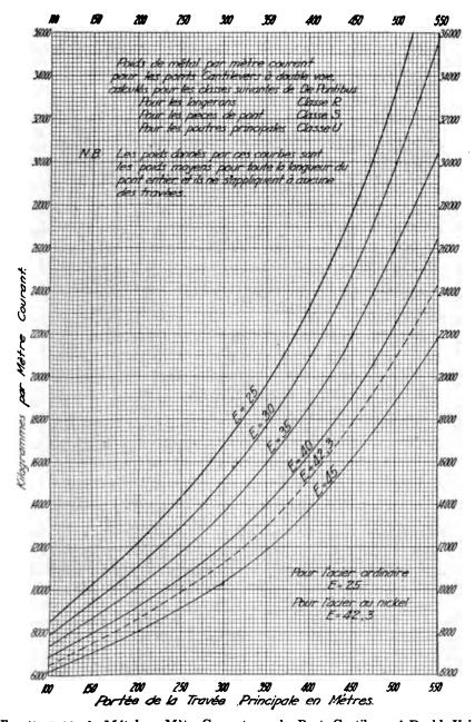
Fig. 4i. Poids de Métal par Mètre Courant pour les Ponts Cantilevers à Double Voie.
