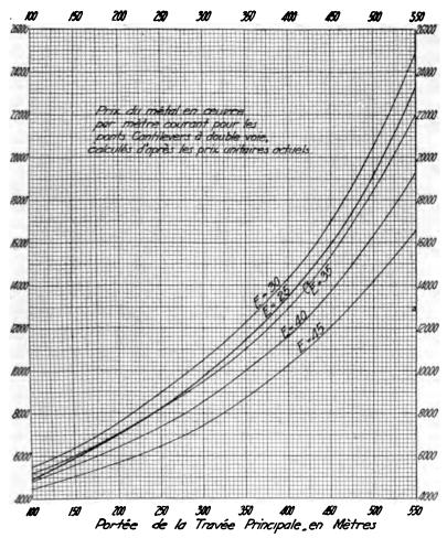
k. Prix du Métal en Œuvre par Mètre Courant pour les Ponts Cantilevers à Double Voie.
